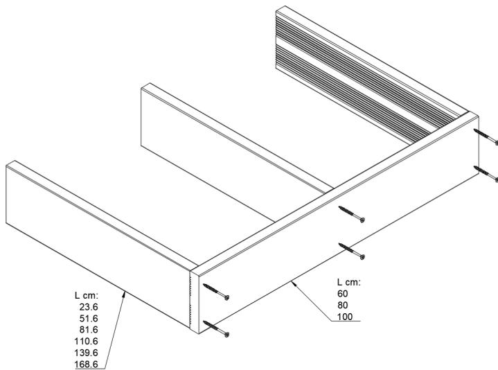
Machen Sie in den folgenden Abständen eine Markierung auf die Oberseite des Brettes, dort werden die „Längen“-Bretter liegen. Sie müssen nicht auf den Millimeter genau sein, Sie werden diese Bretter später sowieso nicht mehr sehen.
