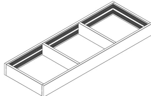
Nehmen Sie die „langen“ Bretter, stellen Sie sie aufrecht und schrauben Sie sie mit 2 Schrauben fest, wie auf dem Bild gezeigt.
