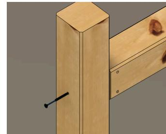
c. Legen Sie die Pfosten auf den Boden, schieben Sie die Querbalken hinein und schrauben Sie sie an jeder Kreuzung mit einer Schraube Ø8x120mm fest.
