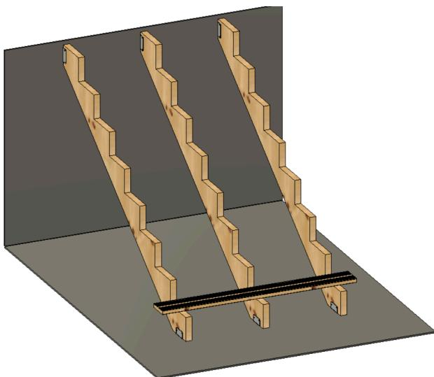
3- Schrauben Sie das erste Brett mit den mitgelieferten Schrauben RT-UT 5x60mm an die erste Stufe (verwenden Sie 2 Schrauben pro Bett, pro Treppenwange). Lassen Sie die Bretter auf beiden Seiten gleich weit über die Treppenwangen herausragen.
