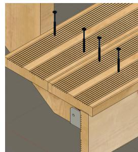
Beachten Sie, dass Sie Ihre Treppenwangen in einem Abstand von maximal 60 cm anordnen; bei Breiten von 80-100-140-160 cm lassen Sie die Stufen über die Treppenwangen hinausragen.
