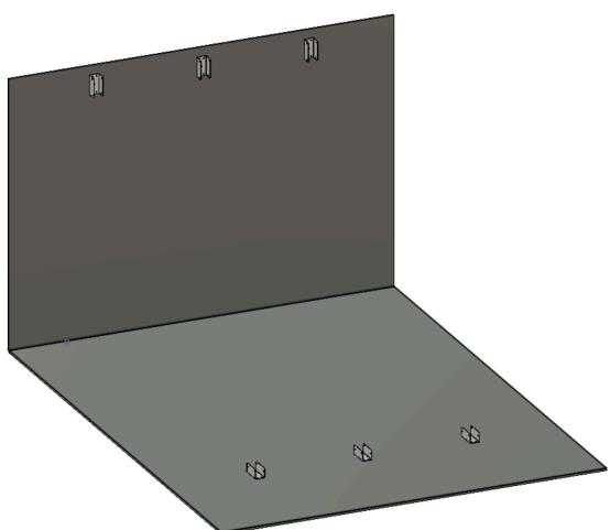
2- Befestigen Sie die Befestigungsmittel Ihrer Wahl an der Wand und am Boden. (Die Befestigungsmittel sind nicht im Lieferumfang der Treppe enthalten, da sie von der Art der Wand oder des Bodens abhängen).
