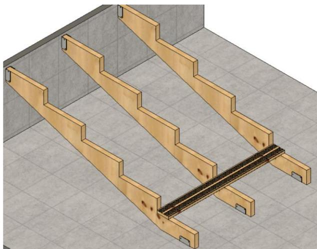
4- Schrauben Sie das erste Brett mit den mitgelieferten Schrauben RT-UT 5x60mm an die erste Stufe (verwenden Sie 2 Schrauben pro Brett, pro Treppenwange). Lassen Sie die Bretter auf beiden Seiten gleich weit über die Treppenwangen herausragen.
