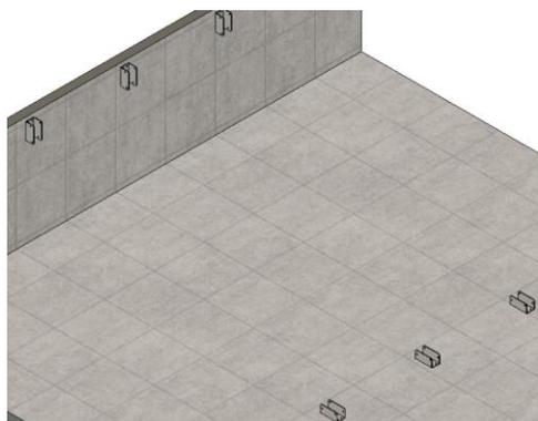
2- Befestigen Sie die Befestigungsmittel Ihrer Wahl an der Wand und am Boden. (Die Befestigungsmittel sind nicht im Lieferumfang der Treppe enthalten, da sie von der Art der Wand oder des Bodens abhängen).
