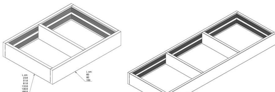
Sitúa de manera vertical las tablas más pequeñas (del centro y de los lados) y dos tablas largas para hacer las paredes y atorníllalas según se muestra en la imagen:
