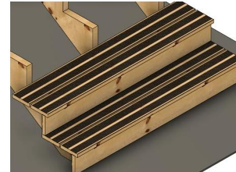
5. A continuación, coloca las dos zancas superiores de los laterales en el soporte.
