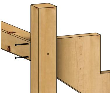
2. Placez le support verticalement et alignez le limon avec le dessus du support, les trous doivent être au centre du limon.
